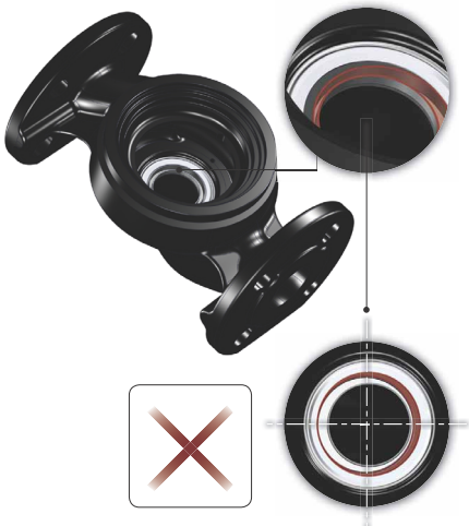
12. ábra Nem megfelelően középre igazított tömítések
